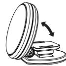
④貼り付ける場所にあわせて台座バーツを動かして調整してください。本製品の上下可動が緩い場合、マグネット部側面にあるネジを締め込むことで動きが硬くなります。
