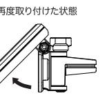
⑥しっかり固定されたことを確認後、マグネット部の上下方向を調整します。
