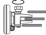
③エアコンフィンにクリップ部をあわせ、ネジ部を右側へ回しクリップ部を閉じます。
