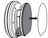
③台座バーツの底面に貼り付けてある両面テープのはくり紙をはがし、好みの場所へ貼り付けてください。
