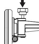
②ネジ部を回す際に、ネジ部が上部に飛び出してきた際、指で押すことでクリップ部が開きます。
