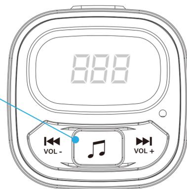
正面左右の周波数調整ボタンで本製品液晶の周波数表示をカーオーディオの FM ラジオと同じ周波数に調整
